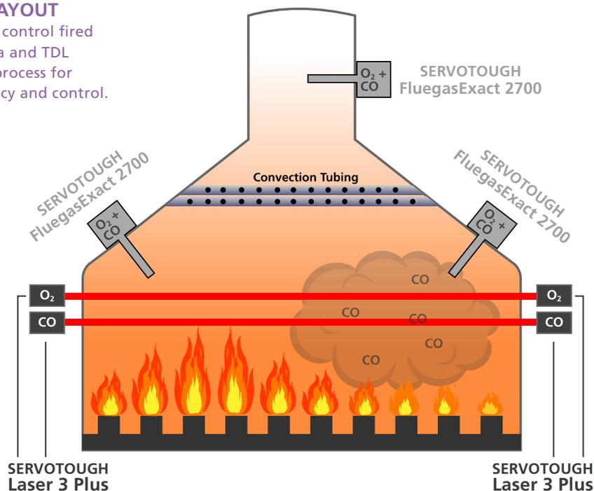
**A COMPARISON OF GAS ANALYSIS TECHNOLOGIES AVAILABLE FOR EFFICIENT AND SAFE COMBUSTION IN CONTROL FIRED HEATERS**
